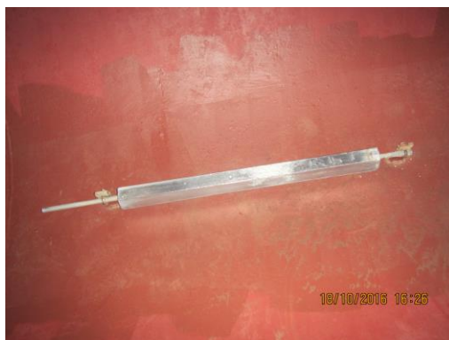
Imagen 13: "Instalación de Ánodos"
